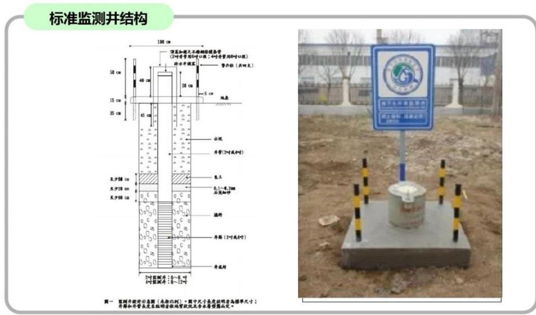
图 5.4-11 监测井结构图及外观
